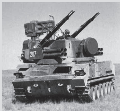
Зенитный ракетно-пушечный комплекс «Тунгуска-М1» 2А38М — 30-мм зенитный автомат
